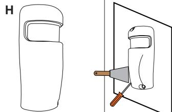
Protezione in pressofusione di alluminio disponibile per serie FIRE / Anti-vandal protection available for FIRE version / Schutzmaske in Pressguss nur für FIRE Version
